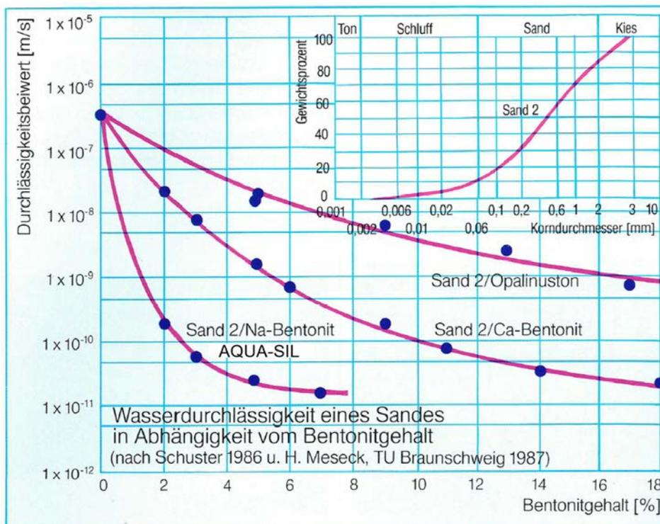
Als Beimischung zum Bentonit eignen sich am besten tonige und schluffige Sande mit einer guten Kornabstufung (Fuller-Kurve). Der abzudichtende Boden sollte bereits nennenswerte Anteile mit einem Korndurchmesser  $<0,06$  mm enthalten.
